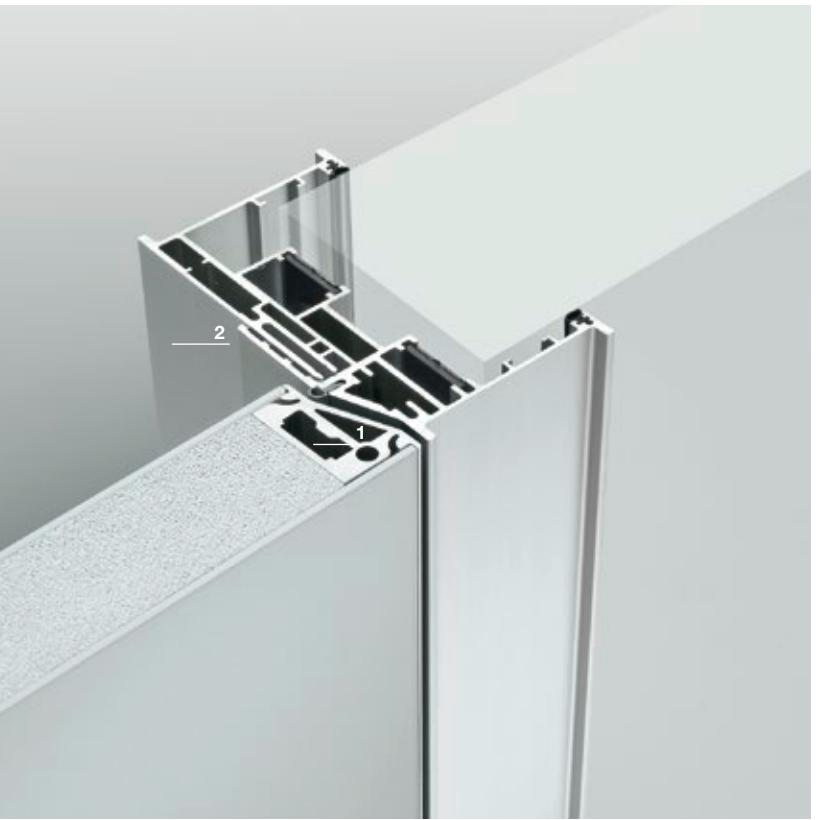
**1** Telai porta in estruso d'alluminio (lega EN AW-6060 stato fisico T6). Ossidazione anodica conforme alle norme EN 12373-1, UNI 10681, UNI 4522-66, UNI 4530
