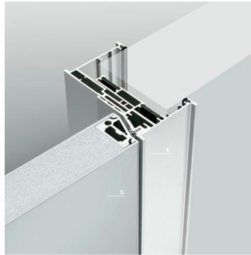
**1** Cadre de porte en aluminium extrudé (alliage EN AW-6060 état physique T6). Oxydation anodique conforme aux normes EN 12373-1, UNI 10681, UNI 4522-66, UNI 4530
