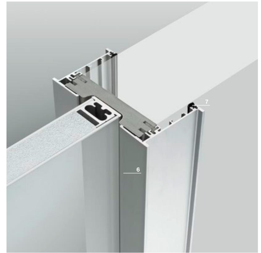
**6** Stipite telescopico per porta scorrevole a scomparsa in estruso d'alluminio (lega EN AW-6060 stato fisico T6). Estensione complessiva compresa fra 107 e 147 mm. Ossidazione anodica conforme alle norme UNI EN 12373, UNI EN ISO 9227, ISO 2370, BS 6161
